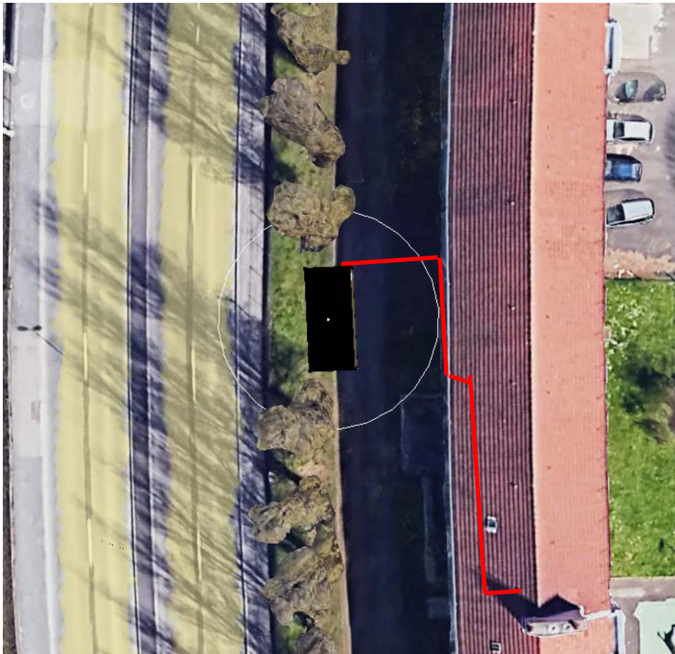
Vue du dessus de l'implantation du site, du module et de ses réseaux de raccordement à la chaufferie existante
