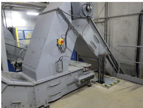
Figure 1. Exemple de coupure cadenassable proche de trappes
