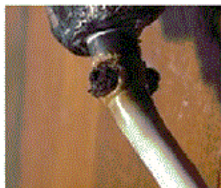
Isolant d'un conducteur dégradé suite à un échauffement
