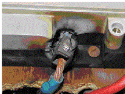
Bornes avec trace d'échauffement d'un dispositif de protection
