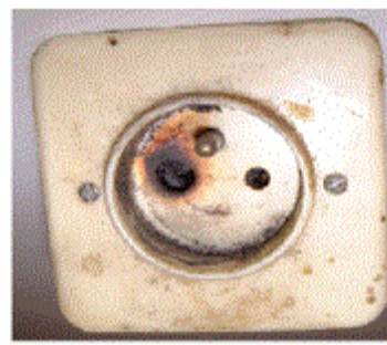
Prise de courant avec trace d'échauffement
