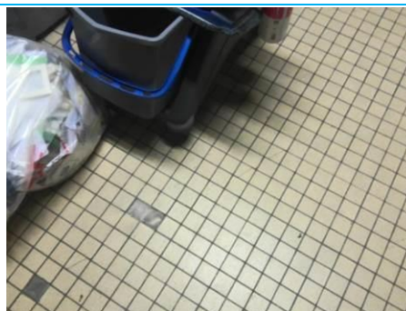
Matériaux : ZPSO-038 Prélèvement : P039 Description : Ragréage Localisation : Rez de chaussée - Garage Résultat : Absence d'amiante
