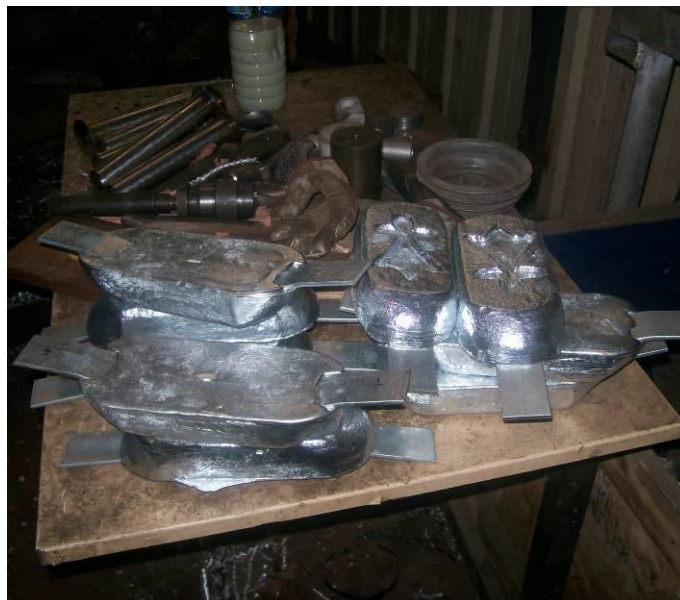
Figure 26 : exemple d'anodes
