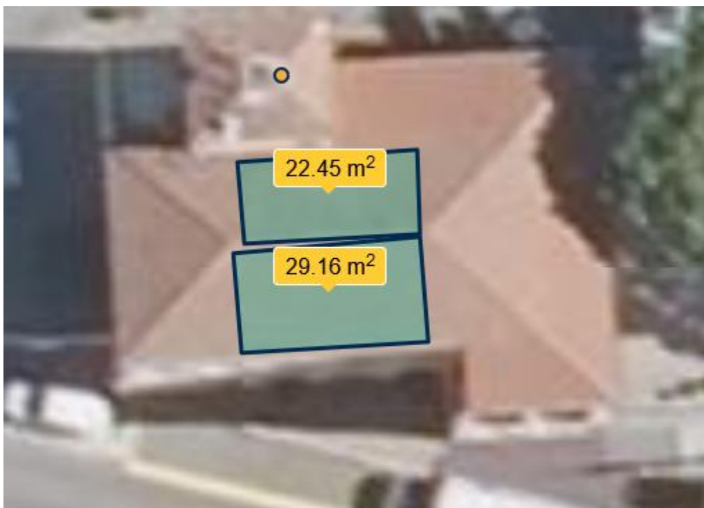
Surfaces dédiées à la mise en place des panneaux photovoltaïques
