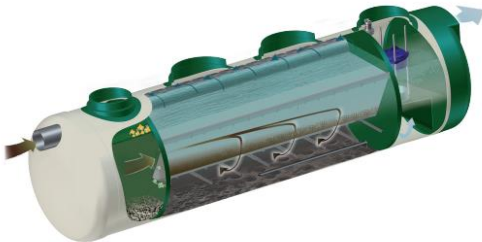
Figure 6 - Schéma de l'Unité de Traitement des aires de Carénage (source : Techneau)
